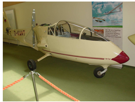
Motorsegler M 76 mit Druckschraube
