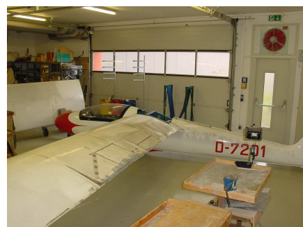
Neuer Anschluss der linken Fläche, auch sichtbar die Korrosionsschäden
