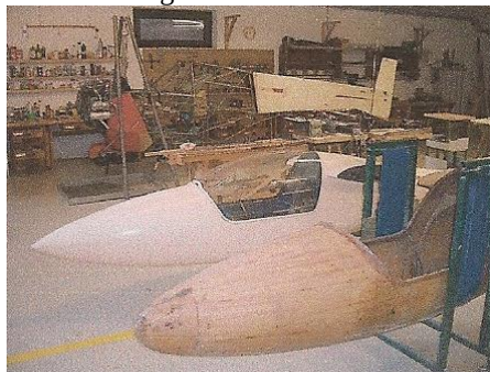
Der GFK-Rumpf der SB 9 hinten und der „Bruchrumpf“ im Vordergrund in der Museumswerkstatt
