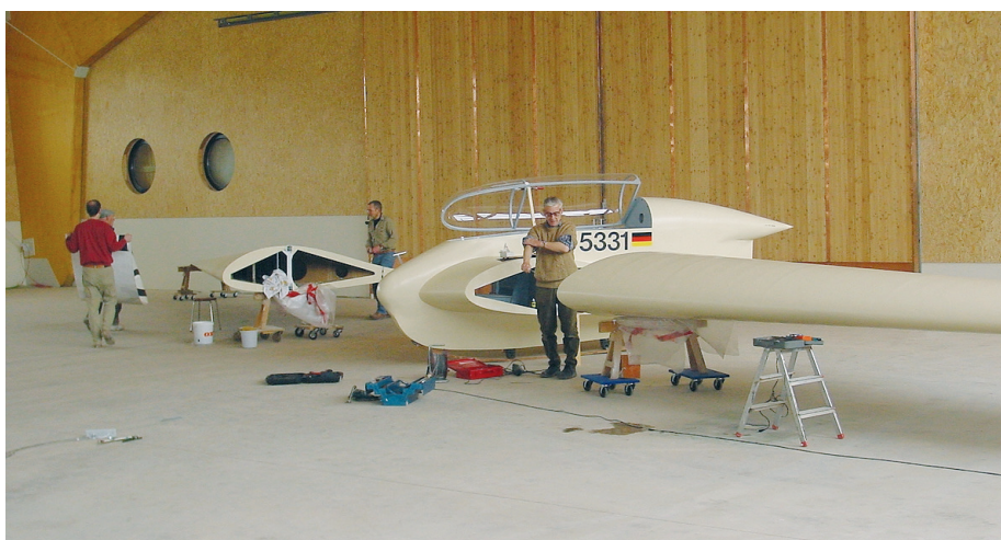
Die Ho 33 wird aufgerüstet
